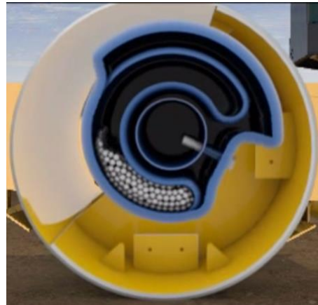
Mynd 5 Lág sveifluvídd. Öxull snýst réttsælis [3].
