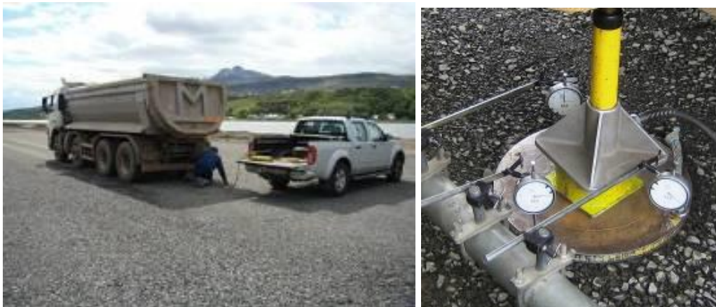
Mynd 8 Plötupróf á verkstað [6].
