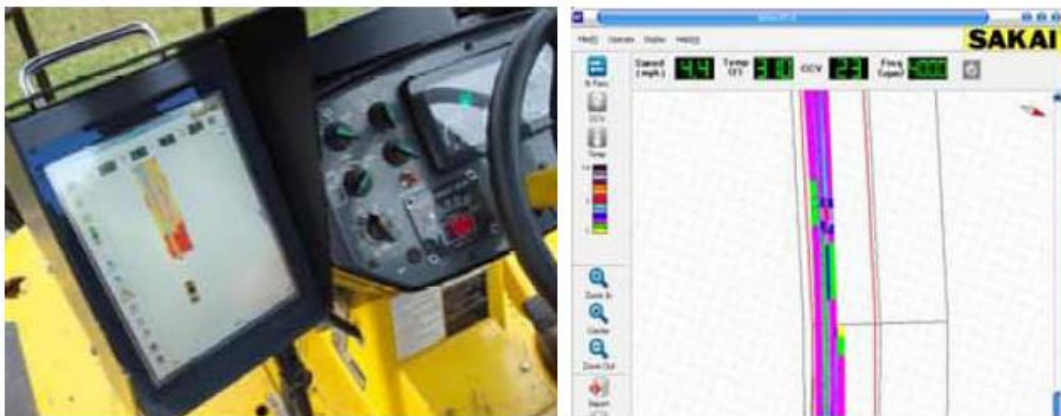
Mynd 47 SkjáBúnaður í stýrishúsi Sakai og skjámynd af þjöppun [17].
