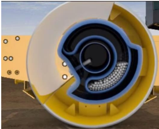
Mynd 4 Há sveifluvídd. Öxull snýst rangsælis [3].
