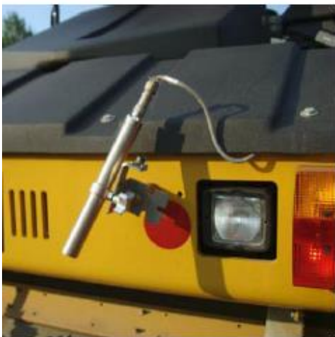
Mynd 19 Innrauður hitanemi festur á valtara fyrir framan tromlu [14].
